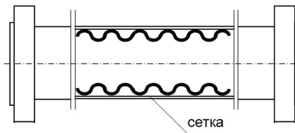
**В.** Гофрированные шланги, армированные сеткой и усиленные проволокой из стали 08X18Н10. DN от 25 до 200 мм. Длина от 0,2 до 6 м. Один фланец – свободный.
