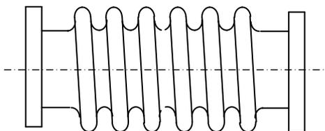
**Б.** Гофрированные шланги, армированные сеткой из стали 08X18Н10. DN от 25 до 200 мм. Длина от 0,2 до 6 м. Один фланец – свободный.
