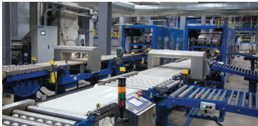
Фото 5. На производстве каучуков внедрены системы технического зрения с применением высокоскоростных видеокамер и аналитики.
