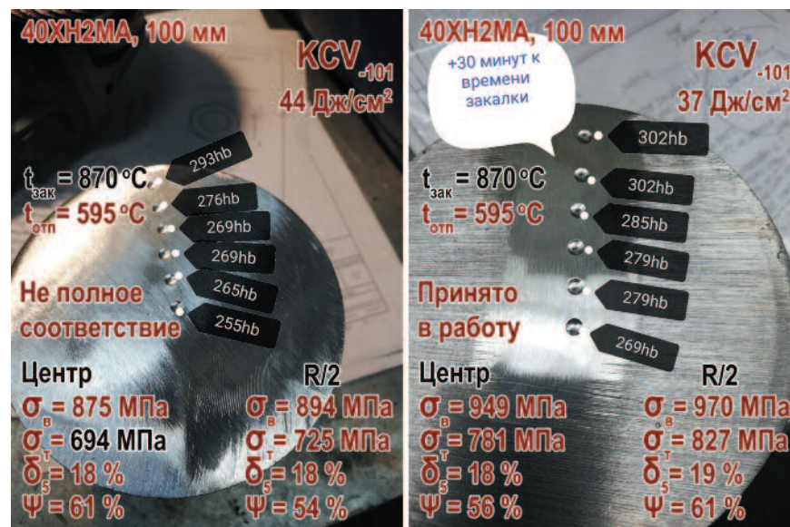
Рис. 2. Влияние времени нагрева 40ХН2МА d100 мм на свойства
